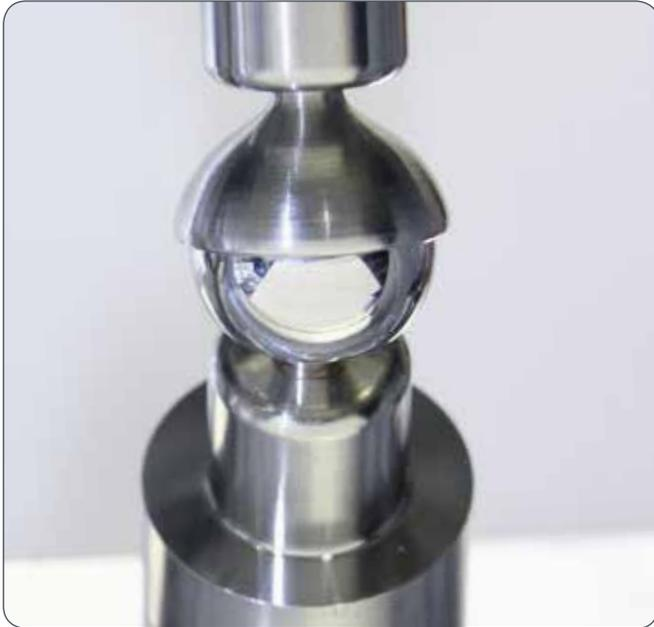
L'essai d'usure a été réalisé à la fois pour le couple MM (métal-métal) et le couple MP (métal-plastique) dans des laboratoires de test en Suède et en Allemagne.
