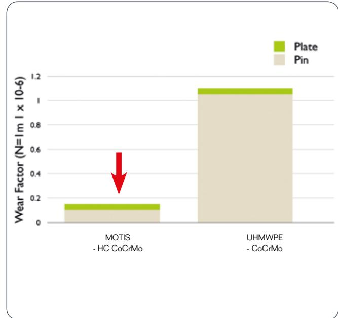
Essai d'usure pion-disque du polymère sur des associations de surfaces d'appui dures.
