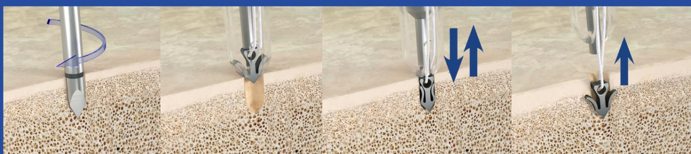
1. Bohrung Ø 2 mm
