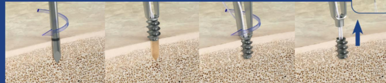
1. Bohrung Ø 1,6 mm
